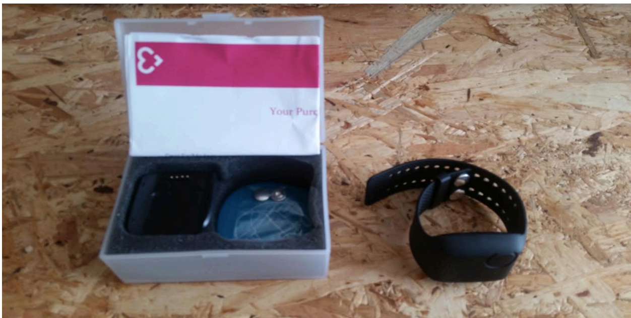
Figure 13. Empatica E4 wristband EDA sensor
